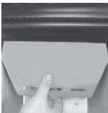
Fig. 16: tourner la plaque coupe-flamme
