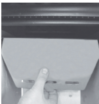
Fig. 16: tourner la plaque coupe-flamme
