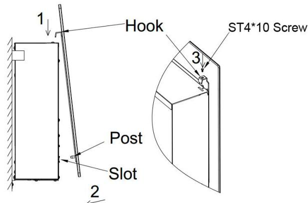
**ÉTAPE 4.** 1. Définir soigneusement les deux crochets du panneau de verre avant dans les encoches sur le bord supérieur avant du foyer. 2. Appuyez sur les deux poteaux du panneau de verre dans les fentes de verrouillage près des coins inférieurs de l'écran du foyer avant. **NOTE :** Assurez-vous que les messages cliquer dans les fentes.
