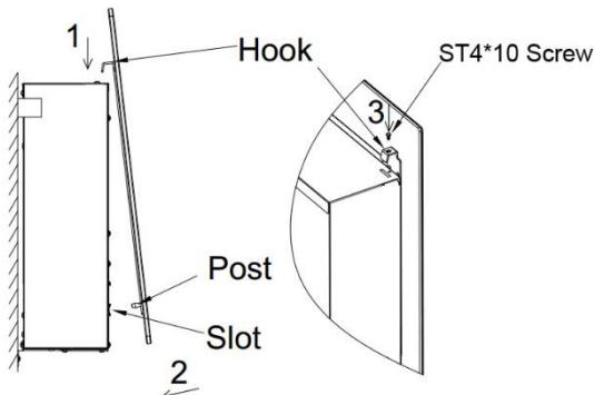
**SCHRITT 4.** 1. Vorsichtig setzen Sie beide Haken der Frontscheibe in die Schlitte an der oberen Vorderkante der Feuerraum. 2. Drücken Sie die beiden Beiträge der Glasplatte in die Verriegelungsschlitte in der Nähe der unteren Ecken des vorderen Feuerraum Panel. **HINWEIS:** Stellen Sie sicher, dass die Beiträge in die Schlitte auf.
