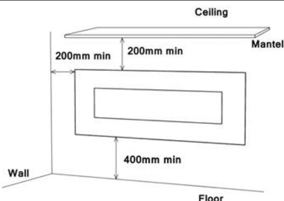
**ÉTAPE 1.** Trouvez un endroit sûr. Distance minimale de chaque côté doit (à gauche, à droite, du plafond) être d'au moins 200 mm; distance minimale par rapport au sol doit être d'au moins 400mm; dégagement minimal de l'avant doit être d'au moins 3.3 pieds (100 cm). Choisissez un emplacement près d'une prise pour une rallonge n'est pas nécessaire. Ne pas placer l'appareil directement sous une prise de courant.
