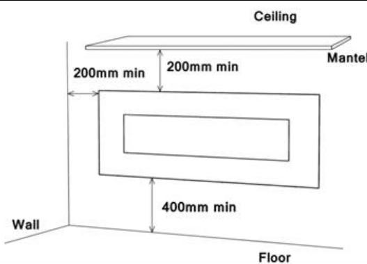
**SCHRITT 1.** Finden Sie einen sicheren Ort. Mindestabstand auf jeder Seite (links, rechts und oben von der Decke) muss mindestens 200mm sein; Mindestabstand vom Boden muss mindestens 400mm sein; Mindestabstand von vorne muss mindestens 3.3 Fuß (100 cm) sein. Wählen Sie einen Ort in der Nähe einer Steckdose, so dass kein Verlängerungskabel erforderlich ist. Stellen Sie das Gerät **NICHT** direkt unter einer Steckdose.
