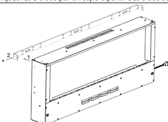
**ÉTAPE 3.** Placez le foyer devant / sur le support (voir 1) et vissez le foyer au support avec les vis ST4x10 sur les côtés gauche et droit (voir 2).
