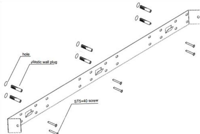
**STAP 2.** Kies een stevige en vlakke muur en plaats de montagebeugel op de gewenste positie. Markeer met een pen de 6 bevestigingsgaatjes van de beugel op de muur.
