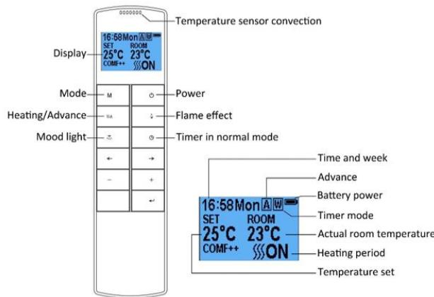
**Belangrijk!** Dit is een afstandsbediening met thermostaat. De afstandsbediening dient ten alle tijden in dezelfde ruimte te zijn als waar de haard zich bevindt en geplaatst te worden op een vlakke ondergrond. Daarnaast moet deze uit de buurt van de kachel worden geplaatst, zodat de hete lucht er niet op kan blazen en de thermostatische aflezing niet kan beïnvloeden.
