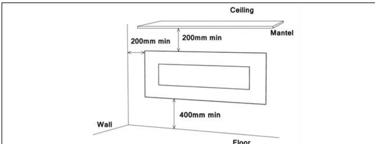
**STAP 1.** Zoek een veilige locatie. Minimale vrije ruimte aan elke kant (boven, links, rechts) moet ten minste 200 mm zijn; minimale afstand van de vloer moet minimaal 400mm zijn; minimale afstand van de voorkant moet minimaal 100 cm zijn. Kies een locatie in de buurt van een stopcontact zodat een verlengsnoer niet nodig is. Gebruik de haard niet direct onder een stopcontact.
