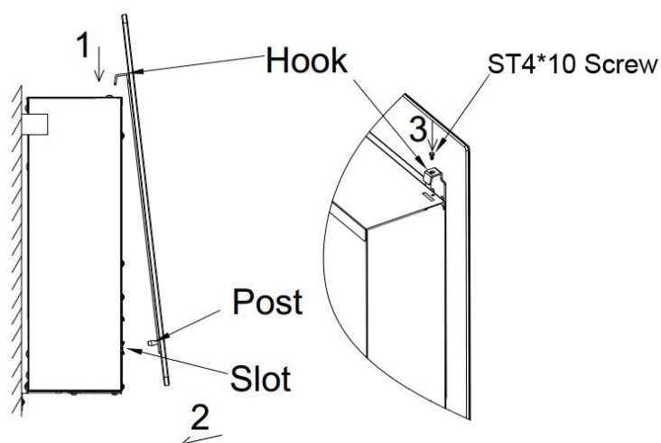
**STAP 4.** 1. Haak voorzichtig het glaspaneel aan de bovenzijde van de sfeerhaard. 2. Druk de onderkant van het glaspaneel in de sfeerhaard, waardoor deze vast komt te zitten. **Belangrijk:** Zorg ervoor dat de glasplaat in de sfeerhaard wordt geklikt.
