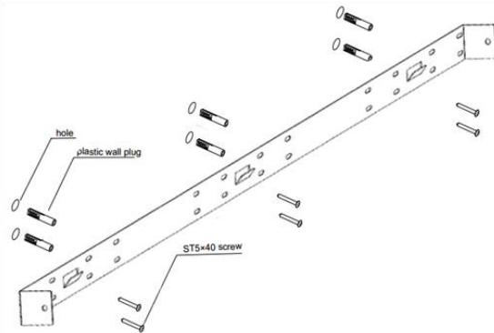
**SCHRITT 2.** Wählen Sie eine solide und einfache Wand und setzen Sie dann die Halterung an der Position, wo Sie wollen, um den Kamin zu installieren. Markieren Sie die 6 Löcher mit einem Stift aus den Löchern an der Halterung.
